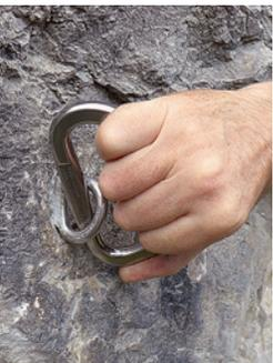
Um Verbundanker („Klebehaken“) zu prüfen, ist der Karabiner-Drehtest eine gute Methode. Mit einem Karabiner in der Hakenöse als Hebel wird mit Handkraft überprüft, ob der Haken sich drehen lässt. Vorsicht: Mit einem größeren Hebel (z. B. Hammer) kann der Verbund zwischen Haken und Fels beschädigt werden.
