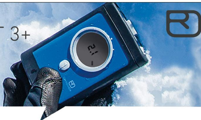
Einzelne Rückmeldungen unserer SAFETY ACADEMY PARTNER haben ergeben, dass es beim LVS-Gerät 3+ mit der Software Version 2.1 in sehr seltenen Situationen zu einer vorübergehenden Störung der Sendefunktion kommen kann. Grund für die Störung ist ein Softwarefehler. Durch die neue Software Version 2.2 wird die Störung ausgeschlossen.
