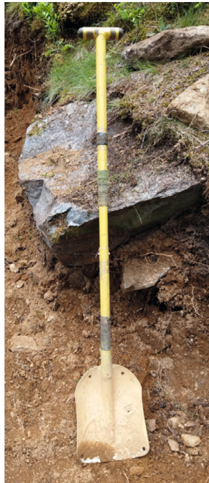
Abbildung 32: Ausrangierte Lawinschaufel mit verlängertem Schaft. Extrem leicht und ausreichend zum Schaufeln von Lockermaterial. Ideal auch zum Glätten und Putzen des Trails. (Foto: C. Piccolruaz)
