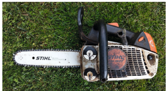
Abbildung 38: Leichte Benzin-Baumpflugesäge für kleinere Arbeiten. Gewicht 3,1 kg. (Foto: C. Piccolruaz)
