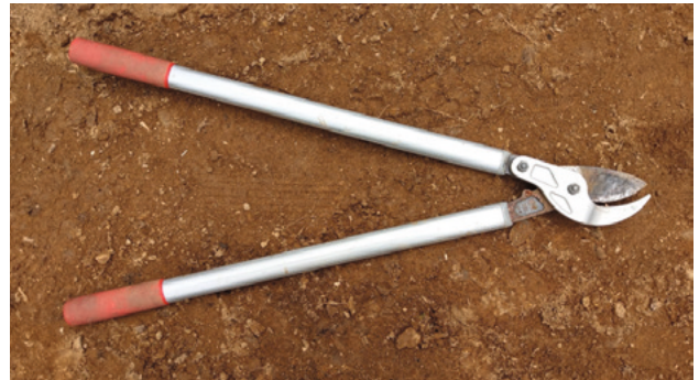
Abbildung 31: Lange Astschere für Wurzeln und Äste. (Foto: C. Piccolruaz)
