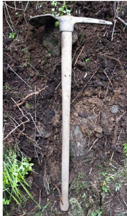
Abbildung 27: Wegmacherhau mit Holzstiel. Universell einsetzbar. (Foto: C. Piccolruaz)
