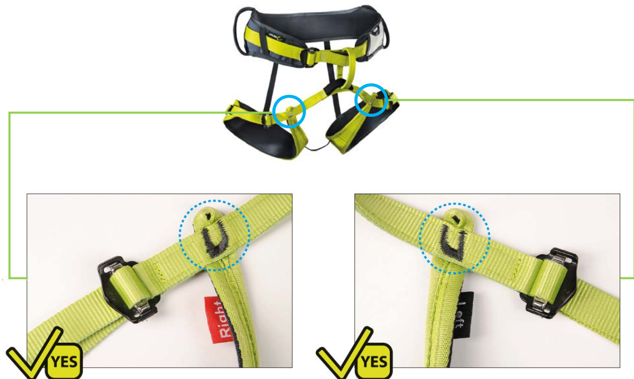
Abbildung 1: Die Nähte an den Beinschlaufen müssen in Kontrastfarbe sein. Das Nahtbild muss dem auf der Abbildung entsprechen.
