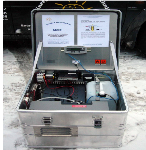
Abbildung 72: Direktmethanol-Brennstoffzelle in Outdoorbox [Elektro Mechanik Meisl GmbH]
