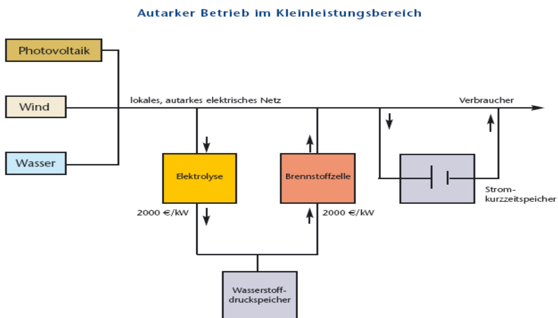
Abbildung 71: Schemazeichnung Brennstoffzelle mit Wasserstoffsystem [53]
